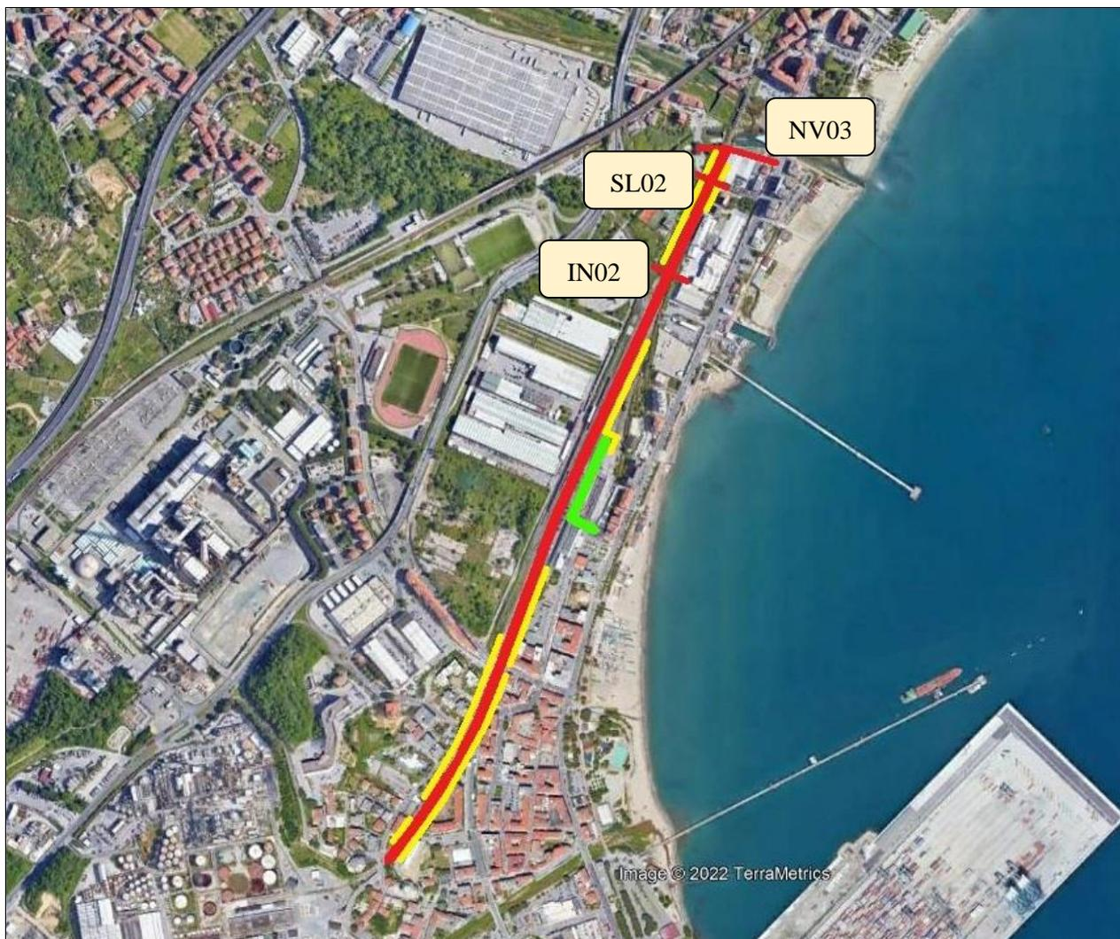
Figura 1. Inquadramento generale dell’area di intervento su ortofoto, in rosso l’ubicazione degli interventi previsti sui binari e gli adeguamenti connessi (NV03, SL02, IN02), in verde l’ubicazione degli interventi presso la vecchia stazione e in giallo le barriere antirumore
