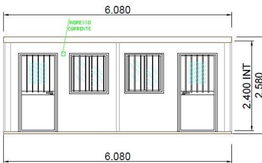
Figura 4.1 – Prospetto monoblocco ad uso locali ufficio
