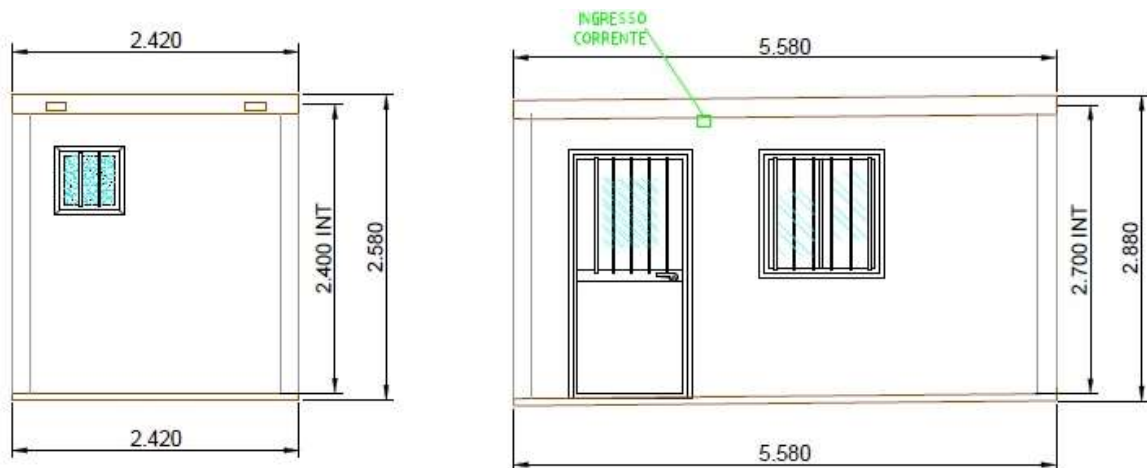
Figura 4.4 – Prospetto monoblocco ad uso spogliatoio + wc
