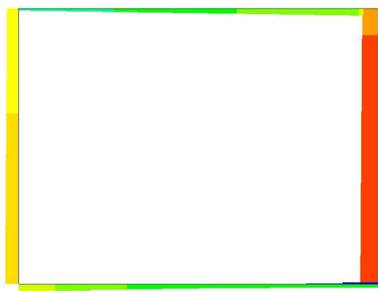
Figura 8.7 - Combinazione SLE Rara – Involuppo valori di Sforzo Normale N
