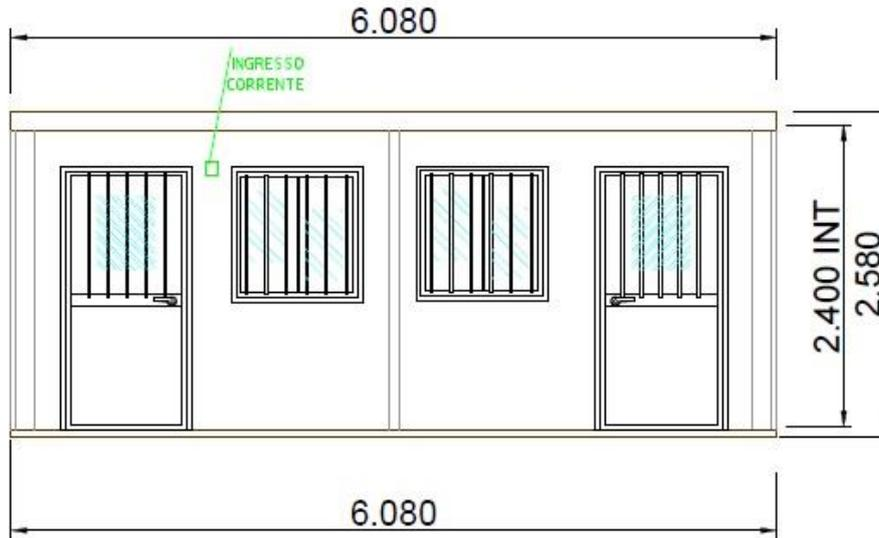
**Figura 14.2 – FA04 - Prospetto monoblocco ad uso locali ufficio**
