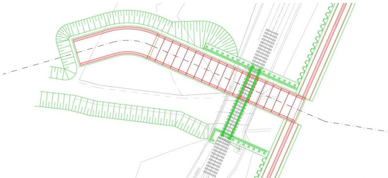
La quinta fase prevede la realizzazione della nuova opera mediante la posa degli elementi scatolari prefabbricati che caratterizzano il manufatto nel tratto sotto binario e la realizzazione dei muri ad U in cls gettato in opera, che raccordano il nuovo tratto con l'esistente.
