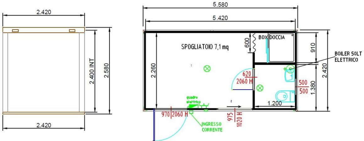
**Figura 14.6 – FA04 - Pianta e sezione monoblocco ad uso spogliatoio + wc**
