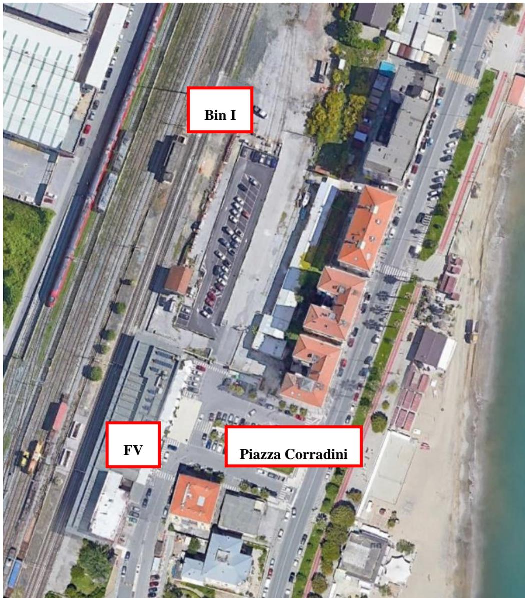
La nuova viabilità da Piazza Corradini entra in area ad uso esclusivo RFI, e con una doppia curva, prima sinistrorsa e poi destrorsa di raggio 11 m evita il parcheggio esistente e si mette parallela al fascio di binari.
