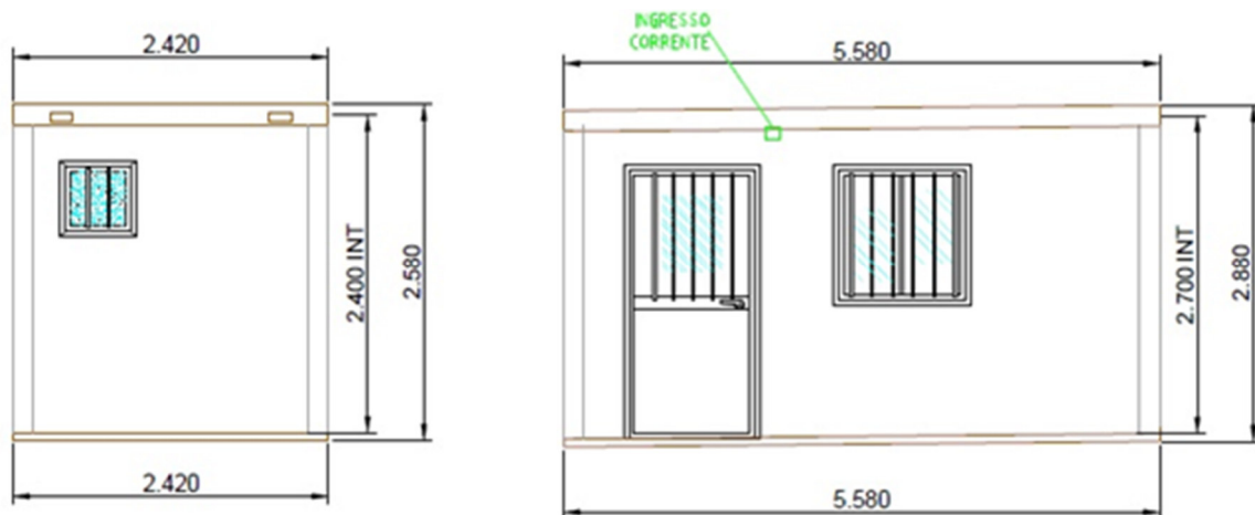
FA04 - Prospetto monoblocco ad uso spogliatoio + wc
