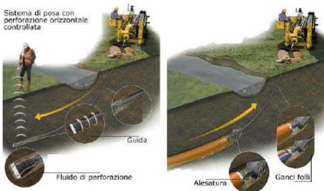
Posa in opera tubazione con trivellazione teleguidata
