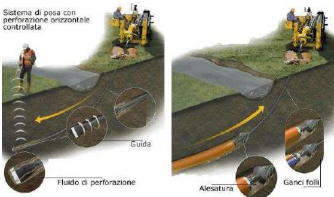
Posa in opera tubazione con trivellazione teleguidata
