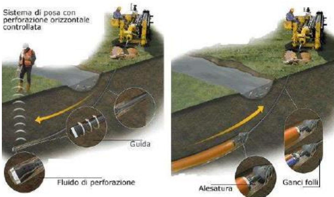
Posa in opera tubazione con trivellazione teleguidata
