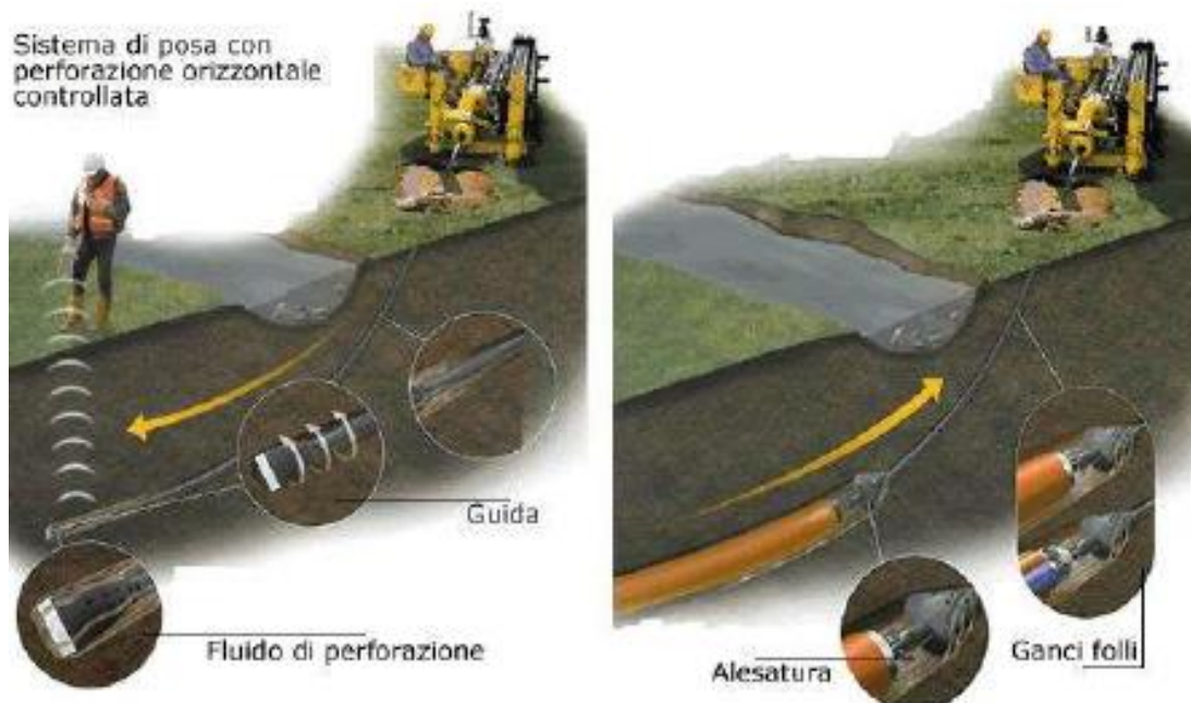
Posa in opera tubazione con trivellazione teleguidata
