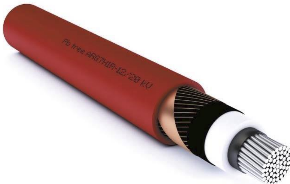
Particolare degli strati costitutivi del cavo MT ARG7H1R 18/30 kV
