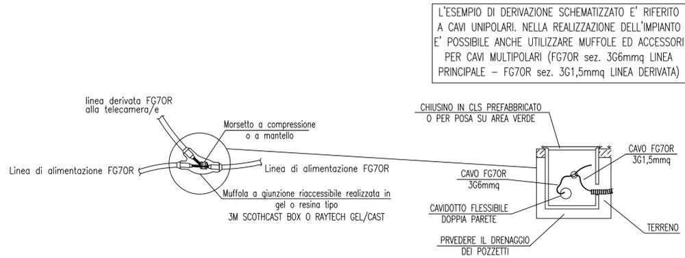
PARTICOLARI DERIVAZIONE CAVI ILLUMINAZIONE DENTRO POZZETTI (non in scala)
