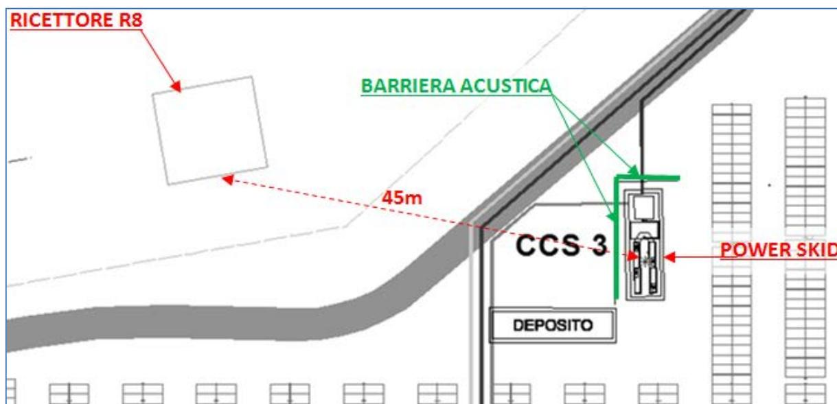
Figura 8 - CAMPO SUD Dettaglio del posizionamento della barriera antirumore in corrispondenza della POWER SKID CCS3
