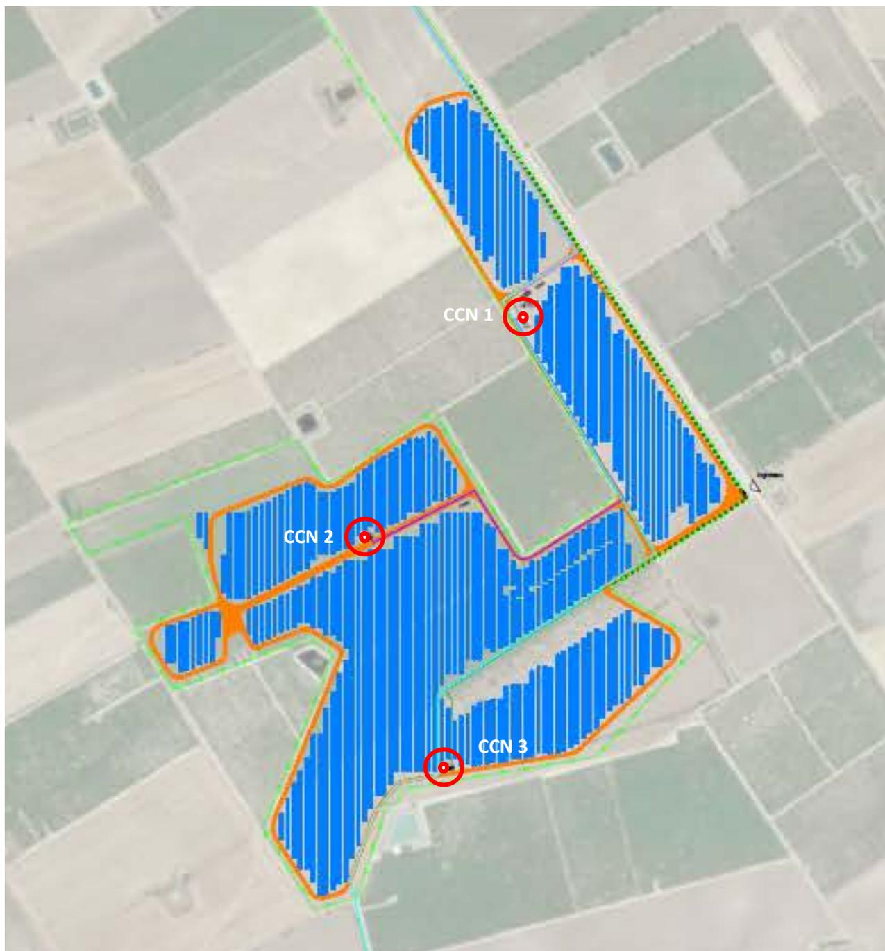
Figura 9 - CAMPO NORD ubicazione POWER SKID (indicate con il simbolo CCN)
