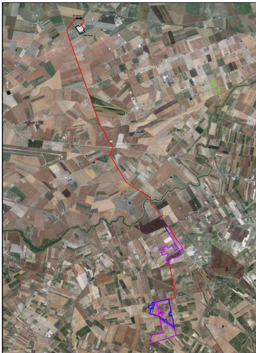
**FIGURA 6 – PERCORSO DEL CAVIDOTTO DO COLLEGAMENTO TRA LE AREE E LA SSE TERNA E SS UTENTE**
