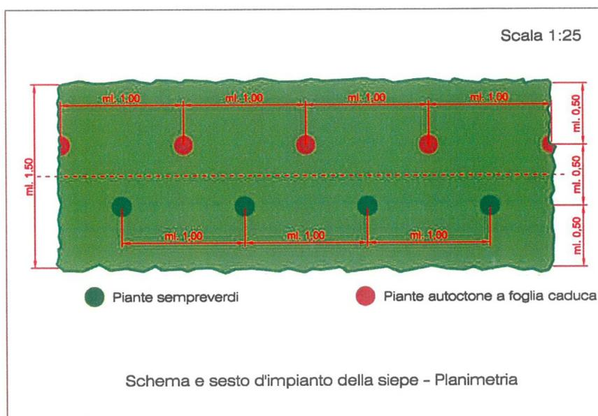
Vista la presenza a sud dell'impianto di un vincolo della soprintendenza "buffer 500 mt", su tale lato si infoltirà lo schema di messa a dimora delle piante autoctone sempreverdi prevedendo due file di piante oltre la fila di piante autoctone a foglia caduca.
