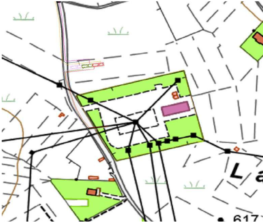
Figura 14 – Cabine elettriche su CTR.
