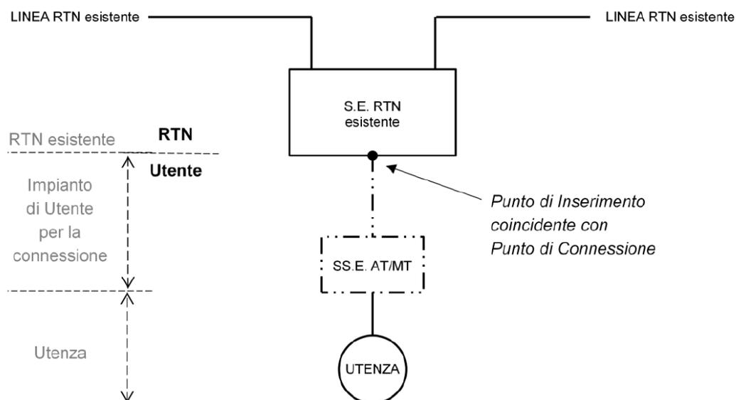
fig. 3 - INSERIMENTO IN ANTENNA
