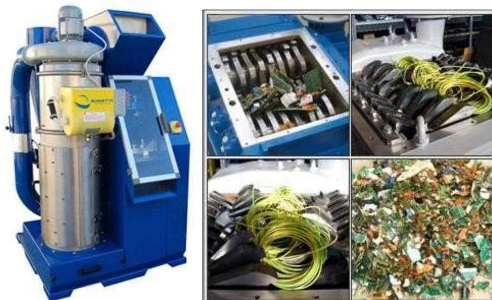
Macchinari simili saranno utilizzati anche per lo smaltimento delle apparecchiature elettroniche quali inverter, trasformatori, quadri elettrici. Il trattamento dei rifiuti da apparecchiature elettriche (RAEE) ed elettroniche è svolto in centri adeguatamente attrezzati, autorizzati alla gestione dei rifiuti ed adeguati al "Decreto RAEE", sfruttando le migliori tecniche disponibili. Le attività di trattamento prevedono varie fasi, indicativamente:
