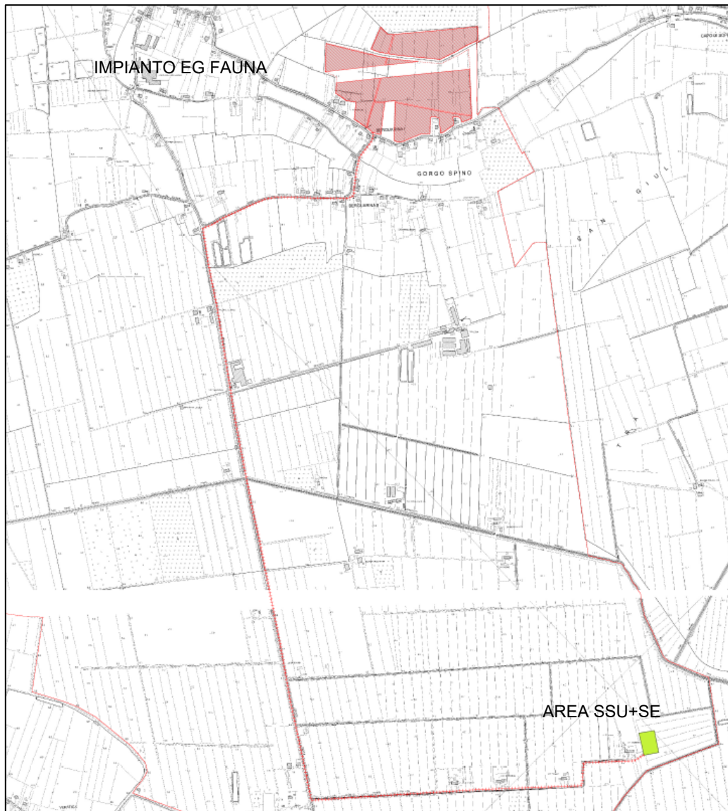
Figura 3 – Tracciato indicativo cavidotto interrato
