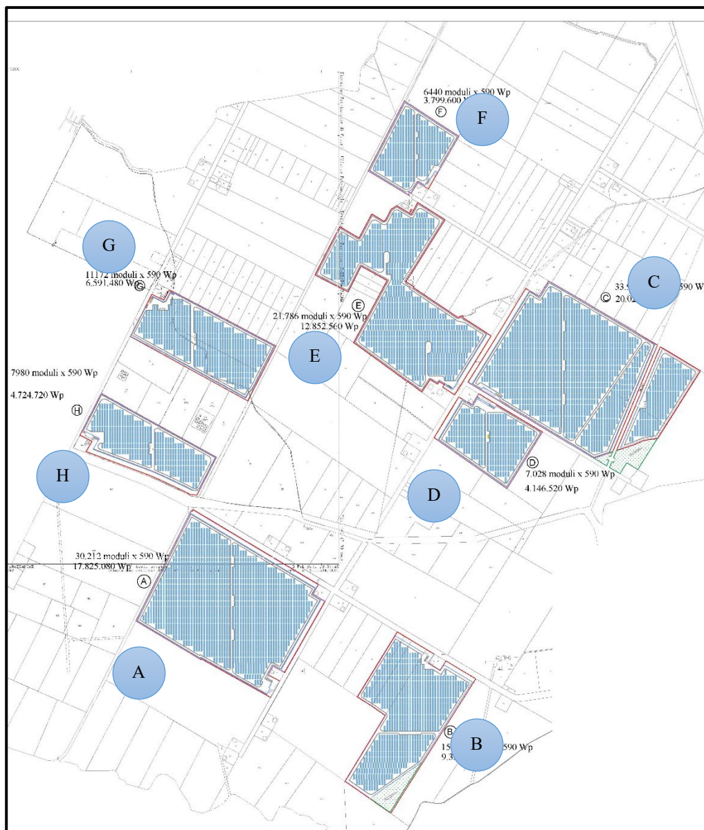
Figura 1: Layout Impianto su base catastale
