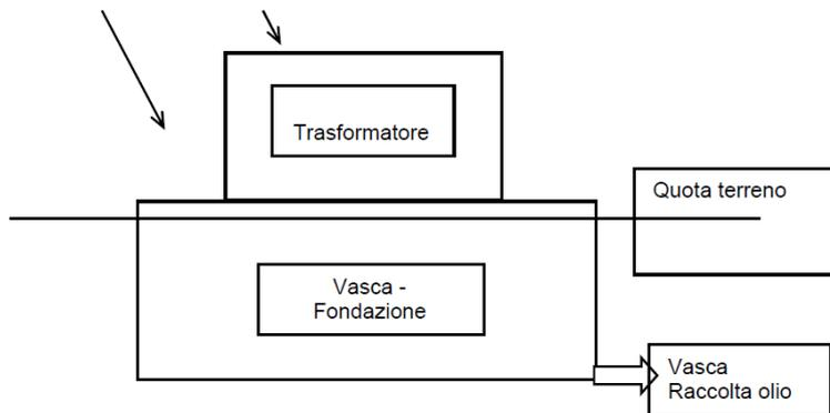
*Fig. 1 - Rappresentazione schematica della funzione della Vasca – Fondazione*
