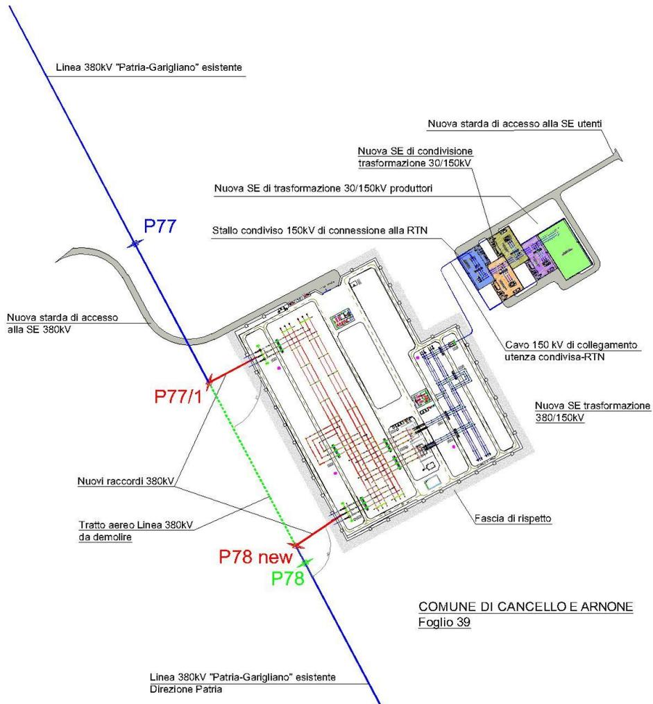
Figure 1: Schema di connessione alla RTN della Futura SE di trasformazione 150/380kV con entra-esce della Linea 380kV "Patria-Garigliano"
