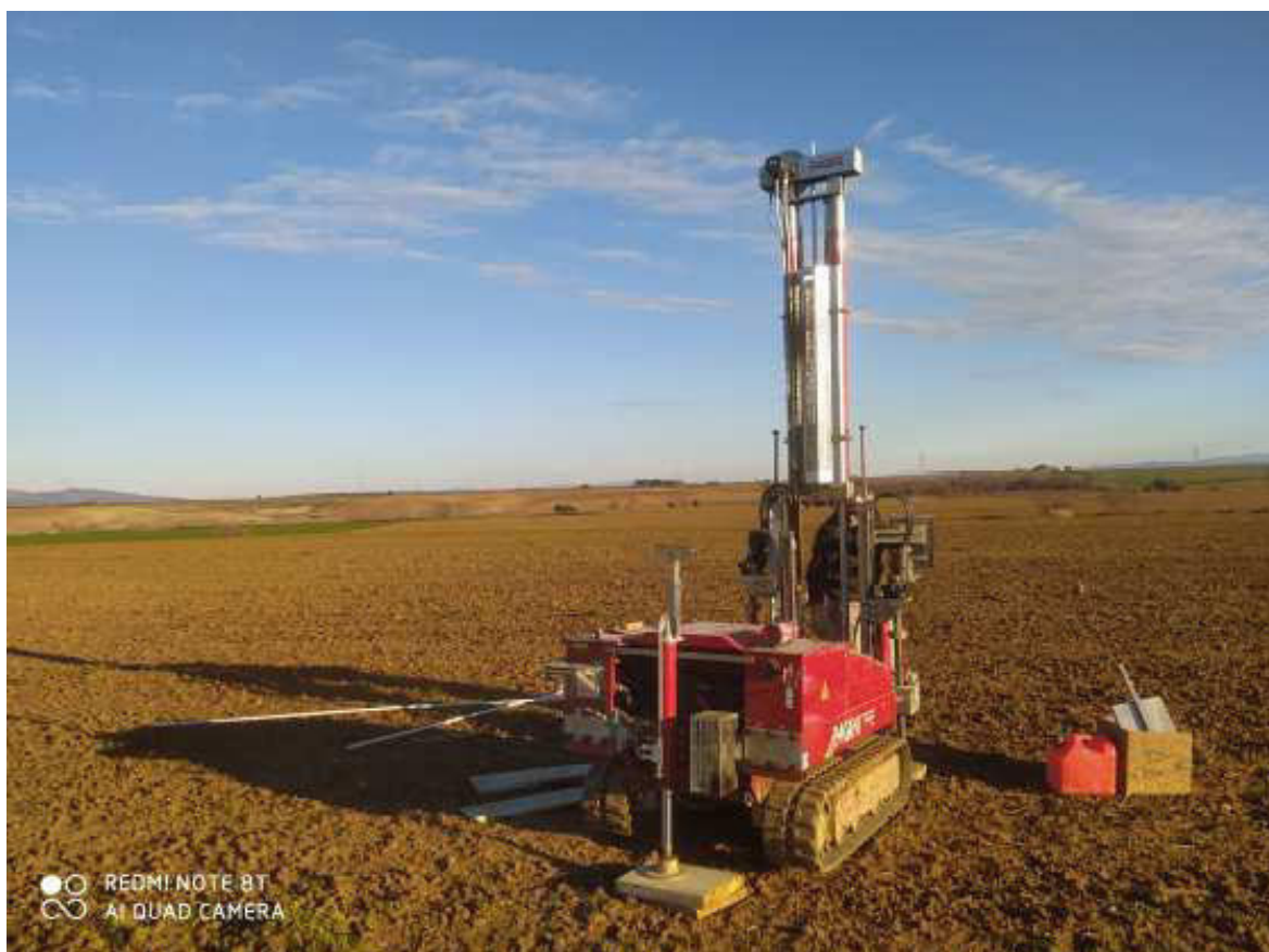
Postazione prova penetrometrica statica CPT5
