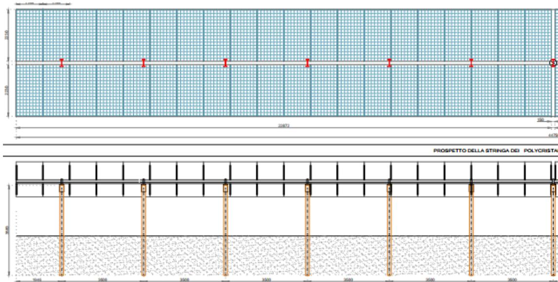
Figura 7. Struttura di supporto e modulo fotovoltaico.
