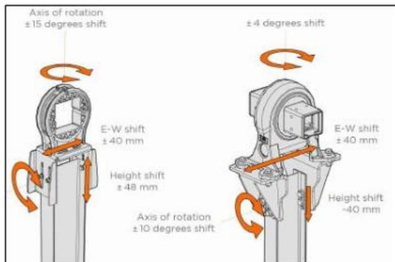
La rotazione viene azionata da un motore posizionato sulla colonna centrale, la quale crea un varco di 15cm sulla superficie fotovoltaica. Il motore è dotato di un sistema di tracker control che permette di inclinare i pannelli fino a  $60^{\circ}$  in funzione alla posizione sul terreno e l'angolo zenitale del sole
