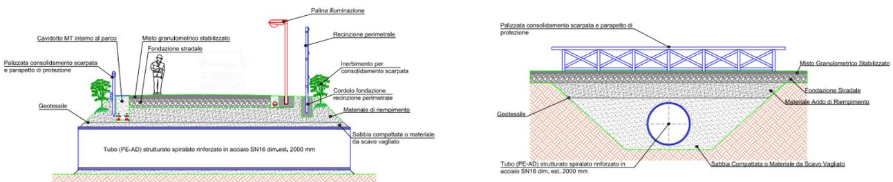
Figura 18. Attraversamenti del reticolo idrografico mediante Trivellazione Orizzontale Controllata (T.O.C.).
