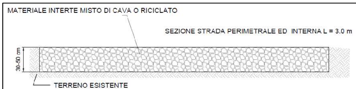
Figura 5-9: particolare strada interna e perimetrale.
