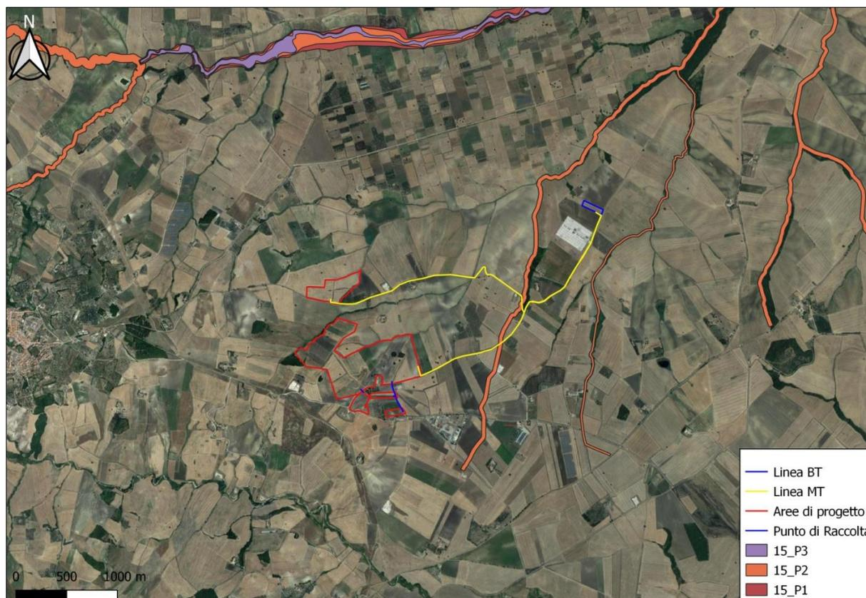
Figura 2-10: mappa fuori scala della pericolosità PGRA; una stretta fascia P2 interferisce sia con il tracciato del cavidotto MT A sia con il tracciato del cavidotto MT B. Nel primo caso, non occorre predisporre adeguato studio di compatibilità idraulica (per i dettagli si veda il paragrafo 4.4.4 dello studio).
