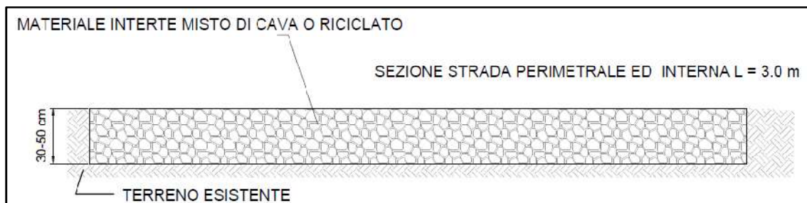
Figura 5-9: particolare strada interna e perimetrale.
