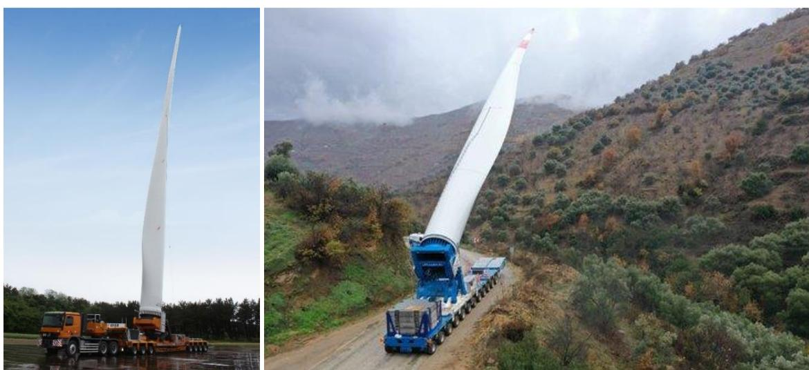
**Figura 22** – Esempio di trasporto con Blade Lifter Trailer
