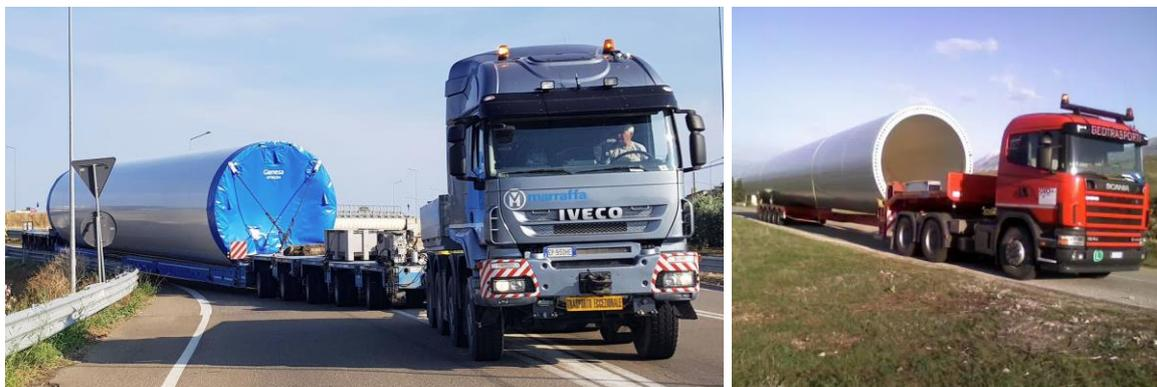
**Figura 23** – Esempio di trasporto con convogli a pianale allungabile per conchi di torre
