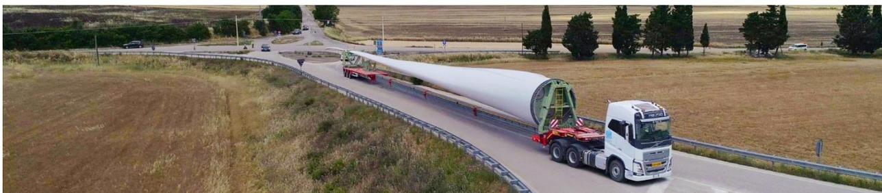
**Figura 20** – Esempio di trasporto con SWC (Super Wing Carrier)
