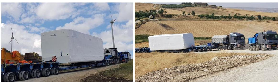
**Figura 24** – Esempio di trasporto Nacelle
