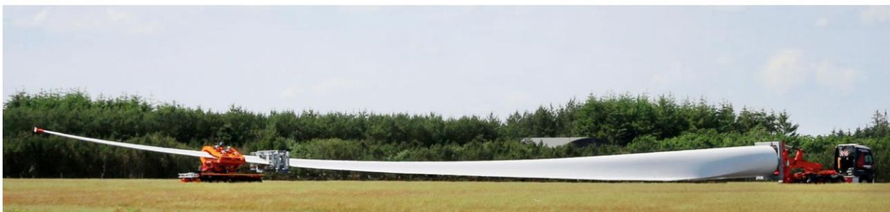
**Figura 21** – Esempio di trasporto con “RBTS” (Rotor Blade Transport System)
