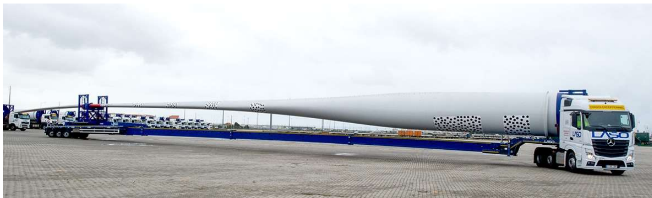
Figura 1 Esempio di trasporto pale con tipologia SWC
