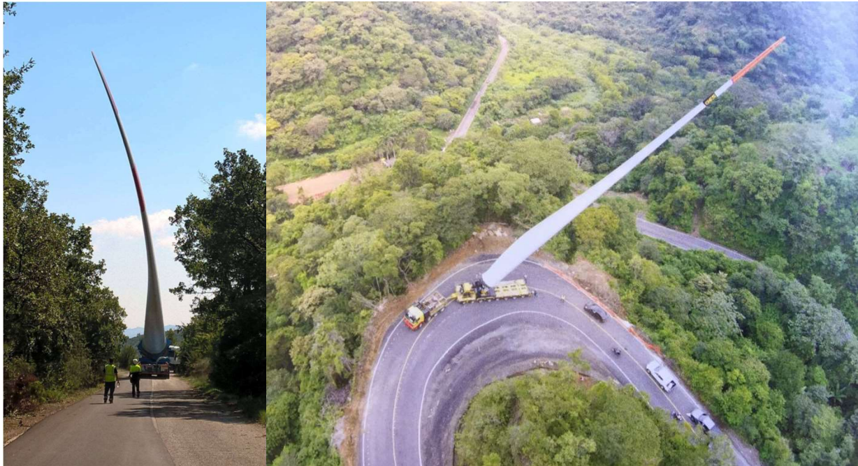
Figura 13 Esempio di trasporto con Blade lifter trailer
