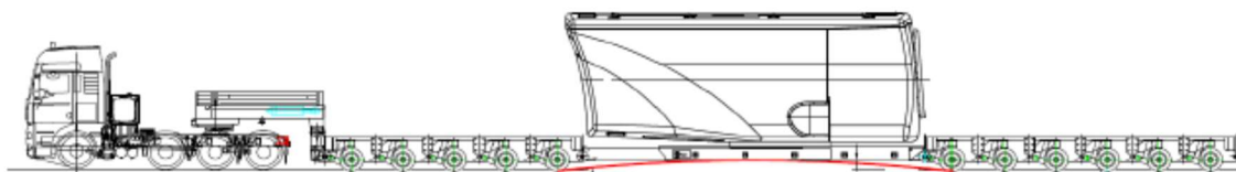
Figura 8 Schema tipo per il trasporto della navicella
