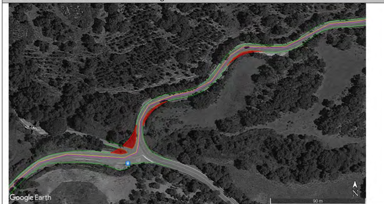
ID Punto n° VI34 – VI 33 – SS133/SP27 – adeguamenti tratti in curva
