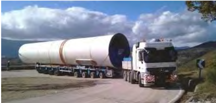
Figura 161 - Soluzione tipo del trasporto dei conici di torre con adeguamento in curva sulla viabilità esistente e del trasporto della navicella
