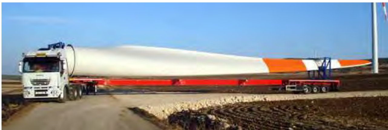
Figura 168 - Soluzione tipo del trasporto delle pale e pista di nuova realizzazione tipo per l'accesso alla turbina
