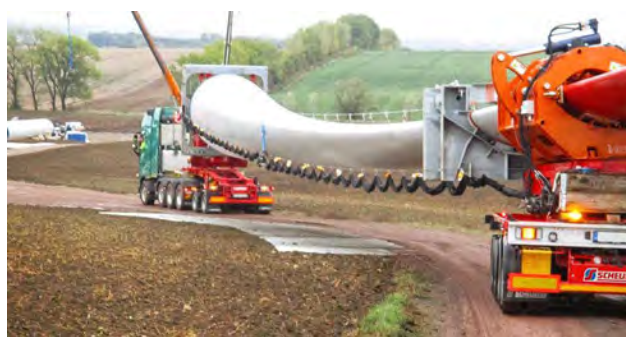
Figure 163 - Esempio di trasporto pale tipologia RBTS "Rotor Blade Transport System"
