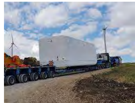
Figura 161 - Soluzione tipo del trasporto dei conici di torre con adeguamento in curva sulla viabilità esistente e del trasporto della navicella
