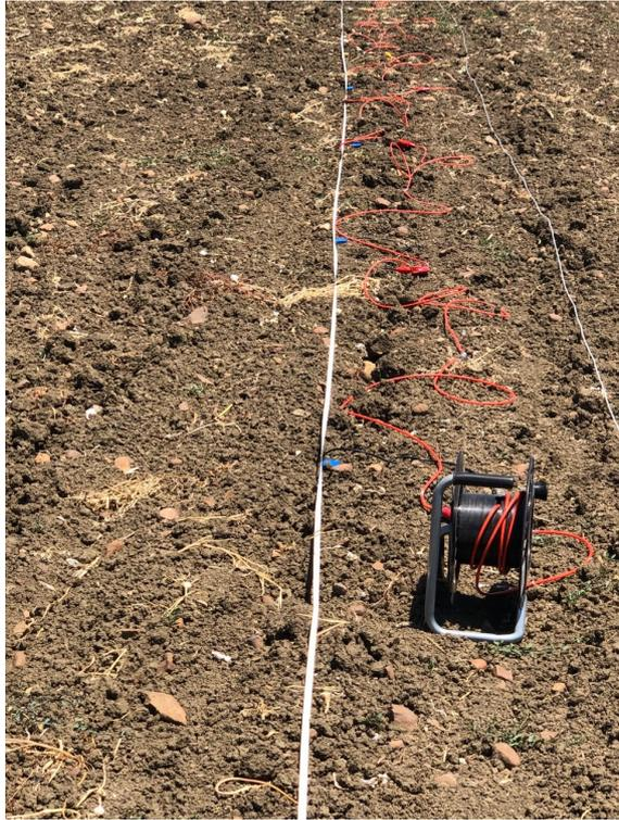
Foto Stendimento di sismica a rifrazione Rz3.
