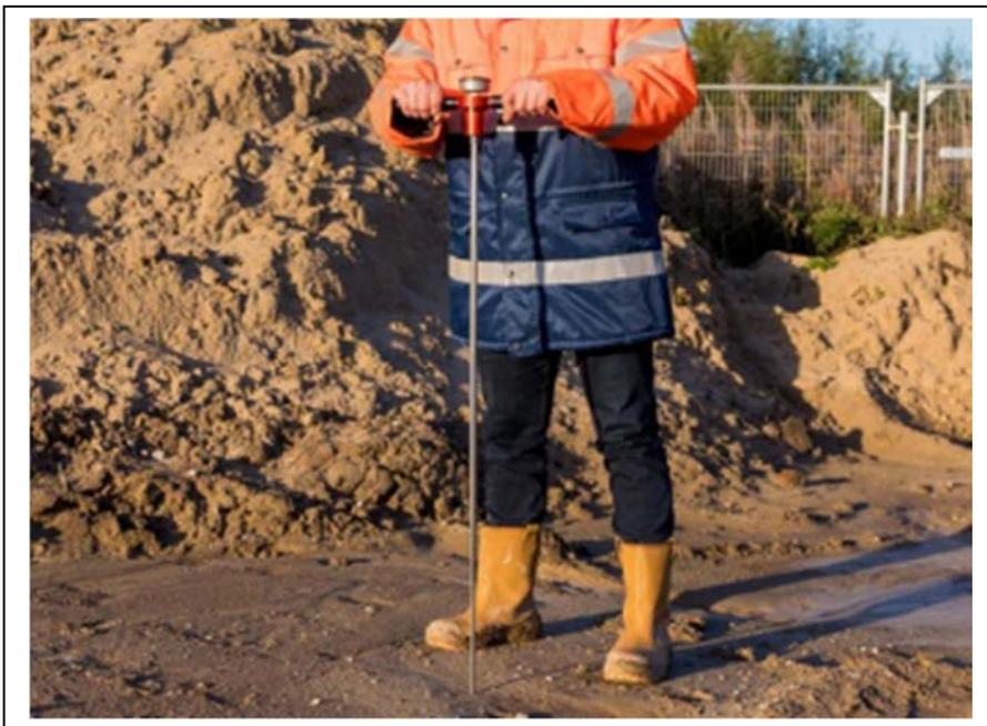
Fig. 10: Penetrometro manuale per misura di densità in situ.
