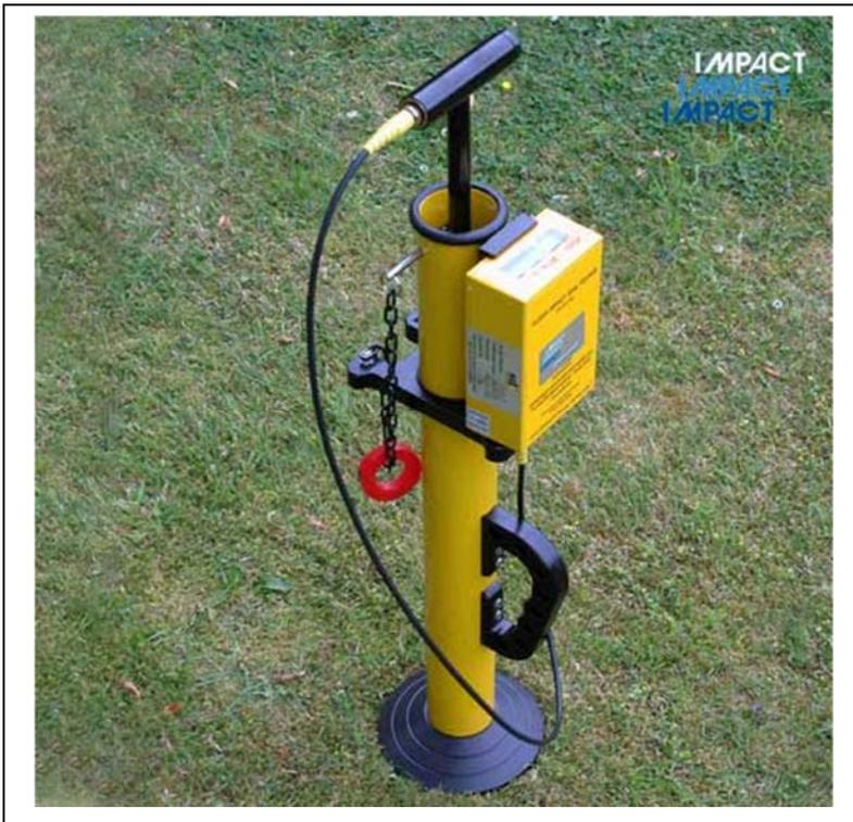
Fig. 12: Strumentazione per Slegg Test
