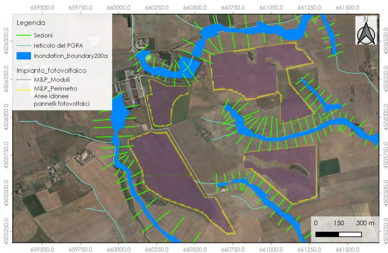
Figura 24: Area Allagabile con T_r=200 anni rispetto alla posizione di installazione dell'impianto Agro-fotovoltaico.
