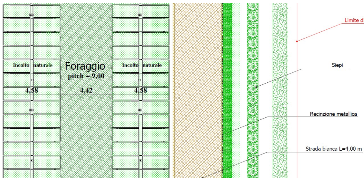
Sistemazione planimetrica Siepi, Strada perimetrale e Tracker
