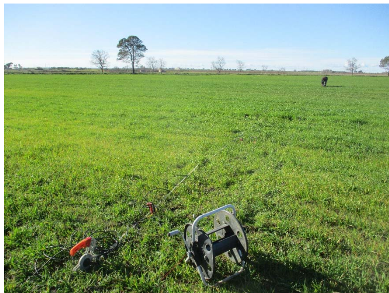
Foto 6 – Profilo sismico MASW3
