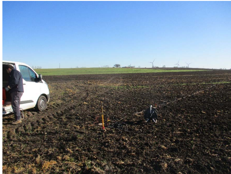
Foto 4 – Profilo sismico MASW2
