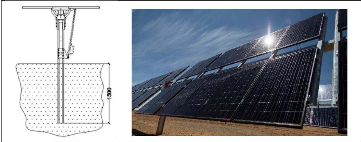
Figura 14. Particolare del sistema di fissaggio dei traker con infissione del palo di sostegno.
