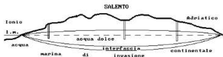
Fig. 5 - Sezione idrologica della Penisola Salentina.
