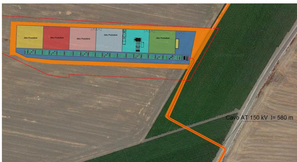
*Figura 10: inquadramento territoriale su Ortofoto del complesso delle Sottostazioni elettriche di Trasformazione dei vari Produttori che condividono la connessione alla RTN*
