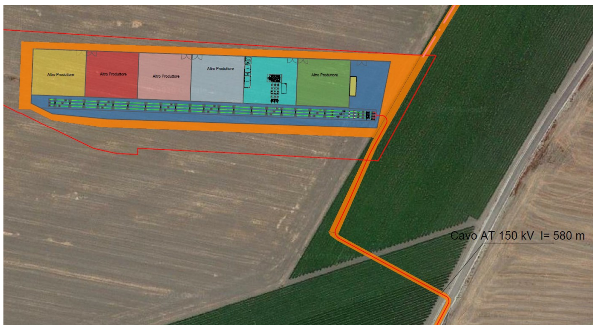
Figura 3: Inquadratura territoriale su Ortofoto del complesso delle Sottostazioni Elettriche di trasformazione dei vari Produttori che condividono la connessione alla RTN
