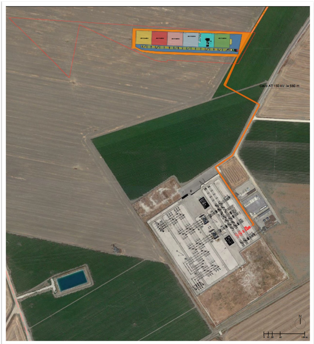
Figura 4: Inquadramento territoriale su Ortofoto del complesso delle Sottostazioni Elettriche di Utenza, della Stazione Elettrica di Trasformazione 380/150 kV di Manfredonia e del tracciato del cavo AT di collegamento
