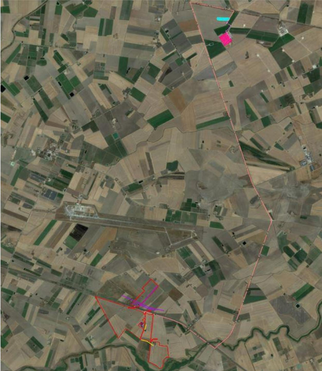
*Figura 1 - Inquadramento Area impianto FV, percorso elettrodotto di collegamento alla RTN e della SSE di utenza*
