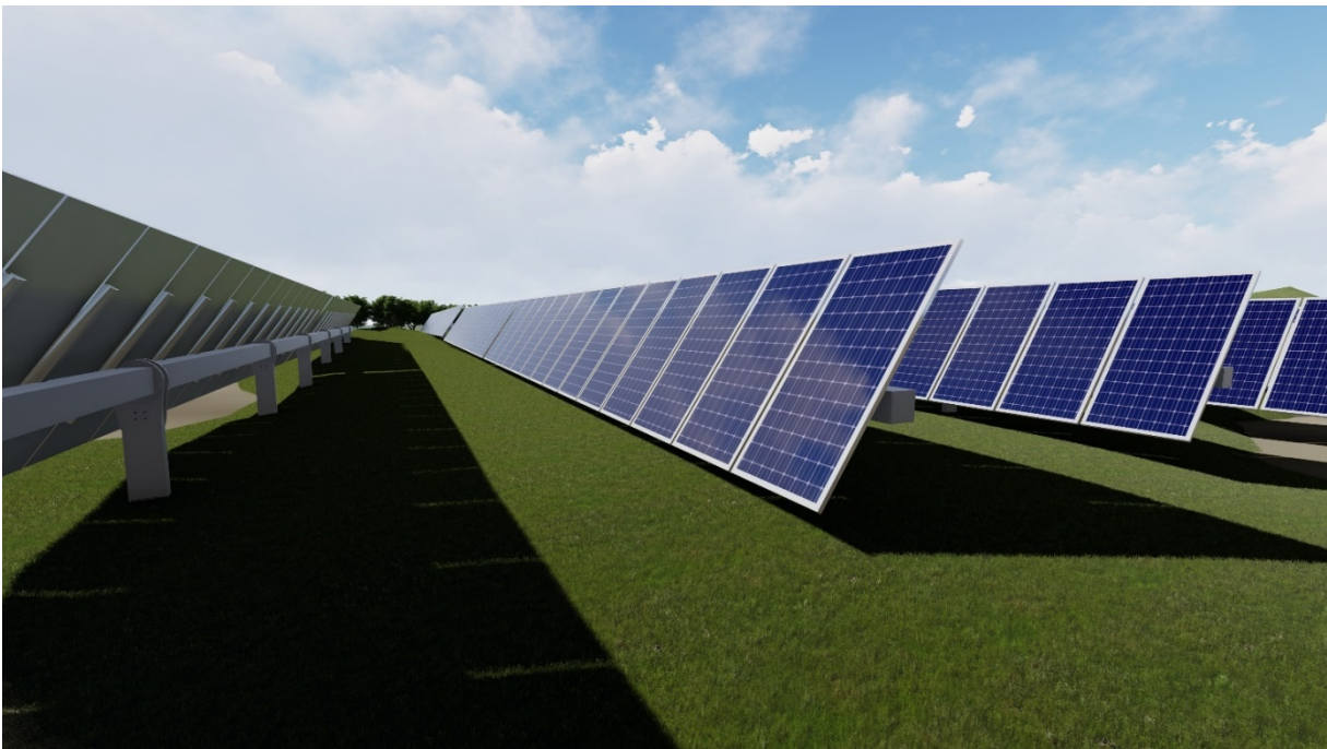
Figura 17 - Render moduli fotovoltaici monovela
