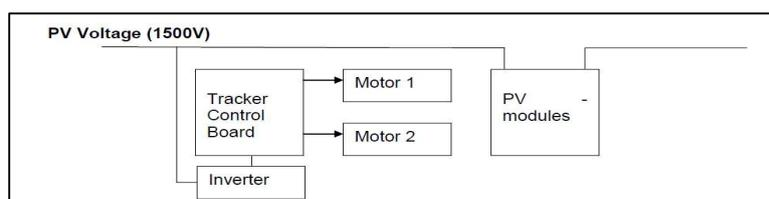
FIGURA 5: ALIMENTAZIONE DEL MOTORE DEI TRACKER DIRETTAMENTE DAL CAMPO FV
