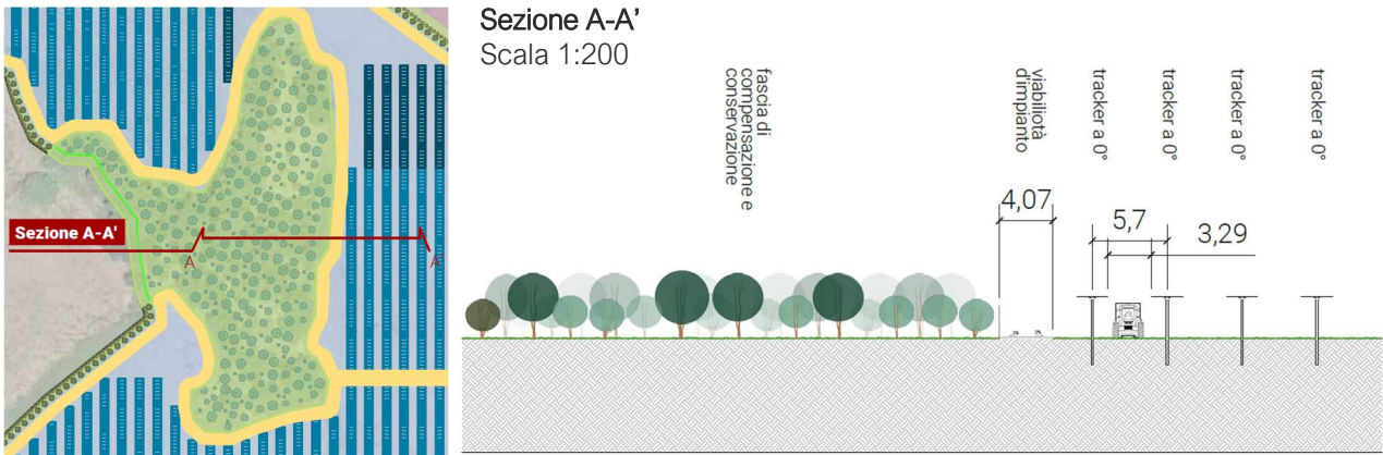
FIGURA 49 – PARTICOLARE AREA DESTINATA A CONSERVAZIONE E RELATIVA SEZIONE O-E DELL'IMPIANTO (ESTRATTO DALL'ELABORATO GRAFICO MACOMER4-PDT11)
