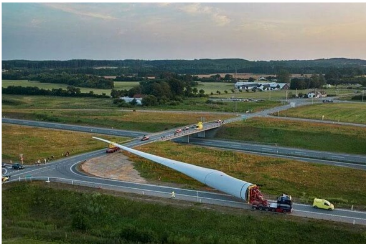
Figura 3 - trasporto eccezionale pala eolica
