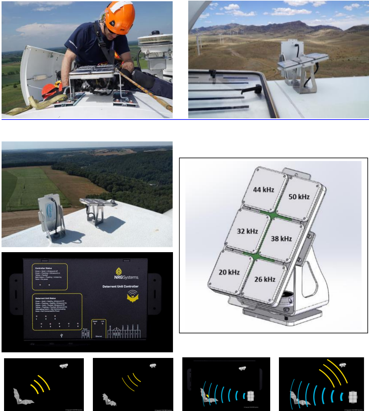
Figura 32. Sopra, il montaggio degli emettitori acustici ultrasonici della NGR, sui lati e sulla parte superiore di una nacella presso un impianto eolico in USA, sopra, e in Belgio, dove l'applicazione ha ridotto la mortalità dell'85% (Sara P. Weaver, C. D.-A., 2020. Ultrasonic acoustic deterrents significantly reduce bat fatalities at wind turbines. Global Ecology and Conservation), grazie anche al software di programmazione ed alla possibilità di dosare le frequenze tra i diversi "emettitori" sulla base delle specie più attive o più a rischio di impatto.
