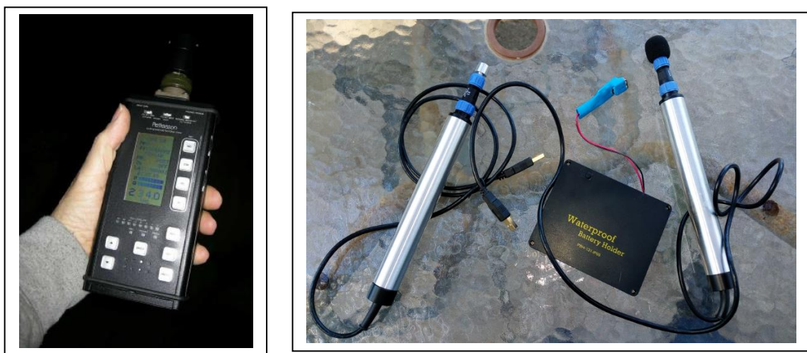
Figura 21. I principali bat detector utilizzati in questo studio: a sx il bat detector multifunzione D1000x Pettersson 1000; a destra i microfoni audio-ultrasonici Ultramic 384K di Dodotron. Entrambi registrano i contatti ultrasonici full spectrum con una frequenza di 384 kHz e con file wav di durata di 5 secondi (su una scheda di memoria interna). L'autonomia degli Ultramic 384K – con power bank di 3 pile D- può arrivare a sette notti continuative, con registrazione su 8-9 ore per notte.
