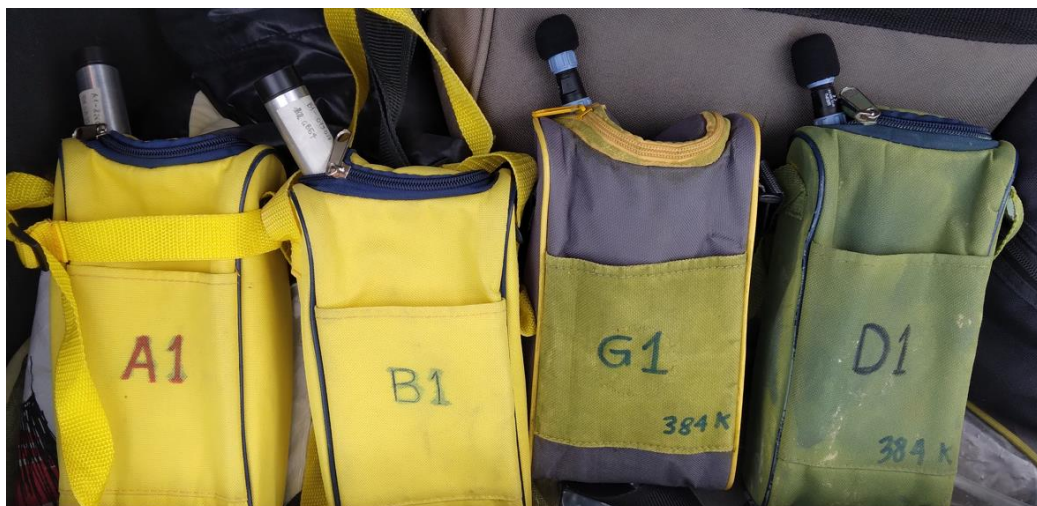
Figura 23. I bat detector Ultramic 384K pronti per essere collocati nei punti di monitoraggio; la piccola borsa termica contiene e protegge i power bank necessari per il supporto di funzionamento.
