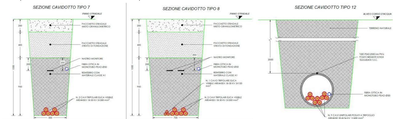
Figura 4 - Alcuni tipici di sezioni cavidotto
