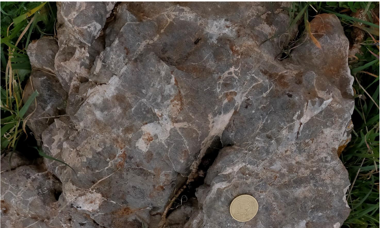
Figura 11 Particolare di dolomia (GNN) nel quale è possibile notare la fratturazione riempita da calcite ricristallizzata.
