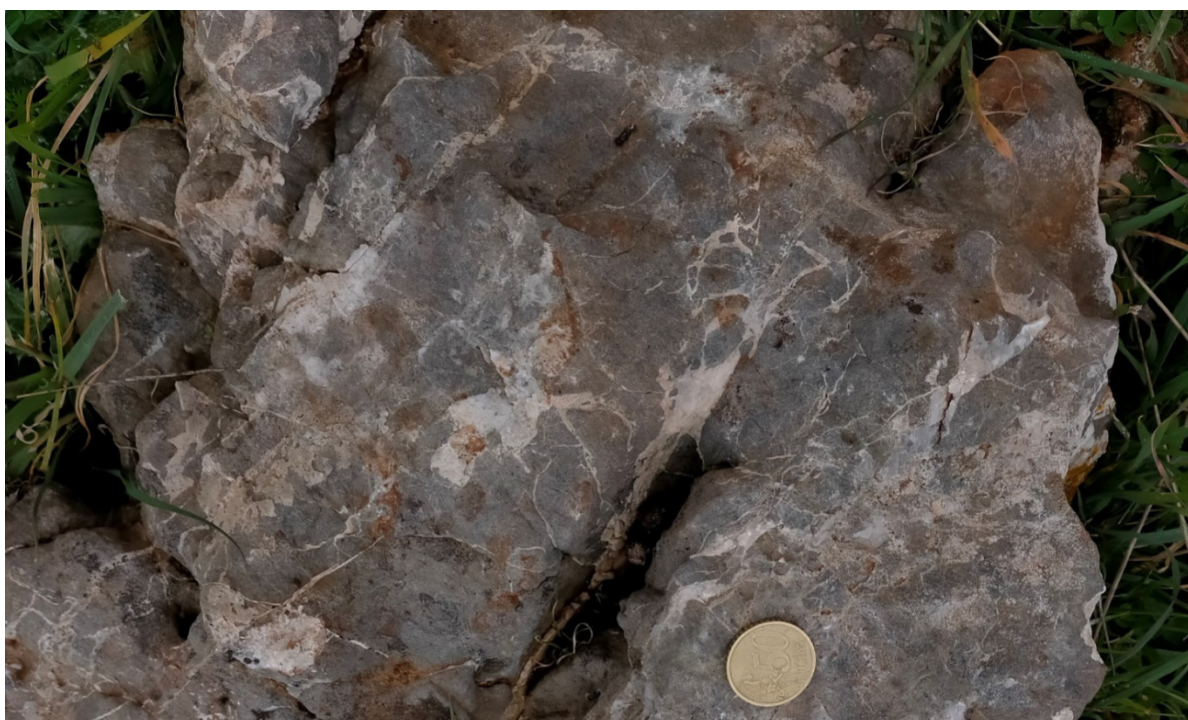
Figura 9: Particolare di dolomia (GNN) nel quale è possibile notare la fratturazione riempita da calcite ricristallizzata.
