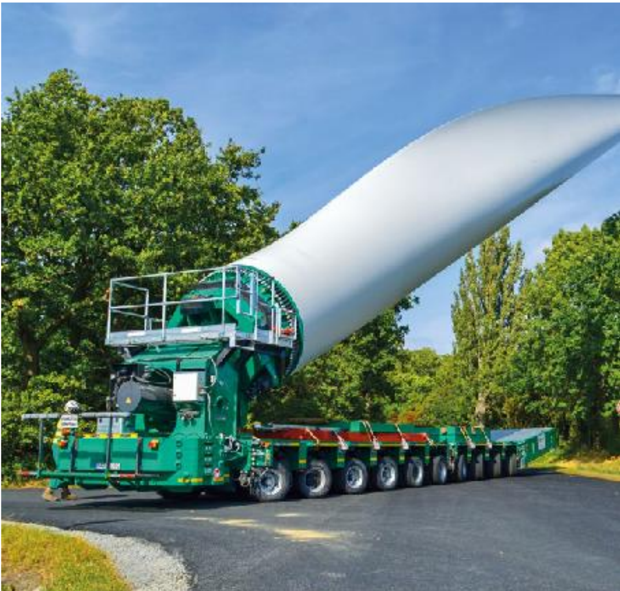
Figura 9: Blade lifter, utilizzato per il trasporto di pale per aerogeneratori.
