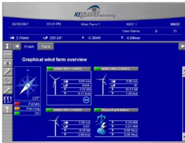
SCADA – Visualizzazione Stato del Parco Eolico.
