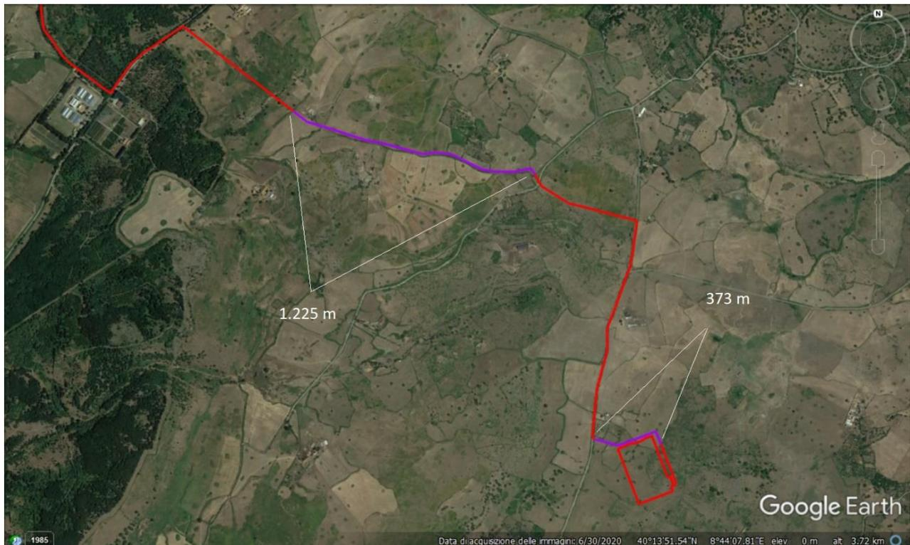
**Figura 31: Distanza di 1.598 m, lungo la quale il cavidotto sottrarrà superficie agricola (Fonte: Elaborazione su Google Earth)**
